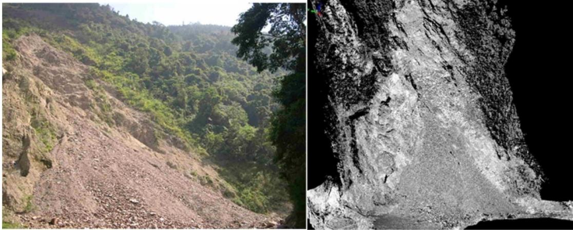
圖 3-20 埔里壩溪測量成果點雲圖
