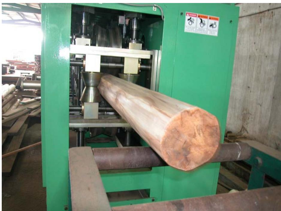
圖 17、圓木棒壓縮加工 2(上下加壓壓縮率 15%)
