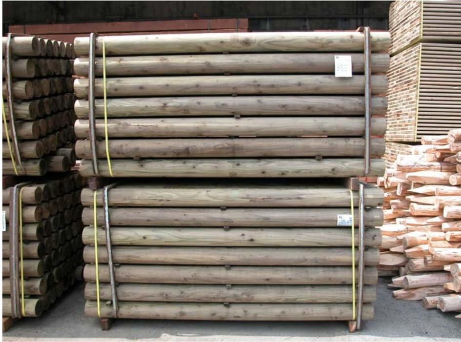
圖 20、圓木棒壓縮後進行 ACQ 加壓注入處理(K4 標準)
