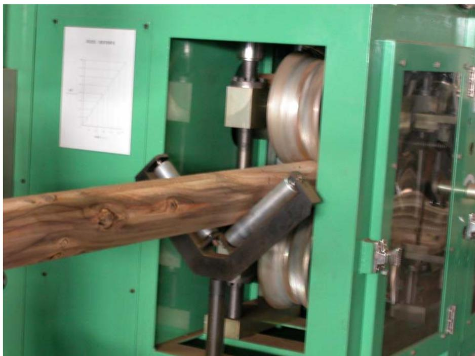
圖 16、圓木棒壓縮加工 1(上下加壓壓縮率 15%)
