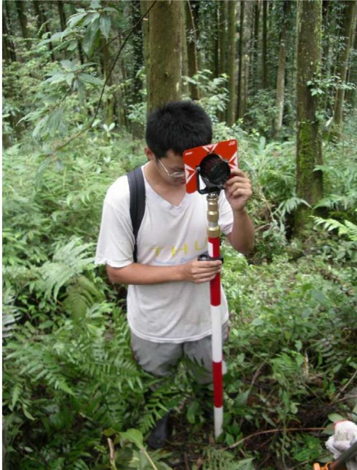
圖五、以圓形氣泡水平儀確定標竿水平。
