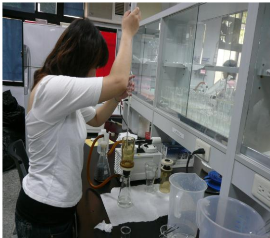
C. 過濾懸浮微粒溶液
