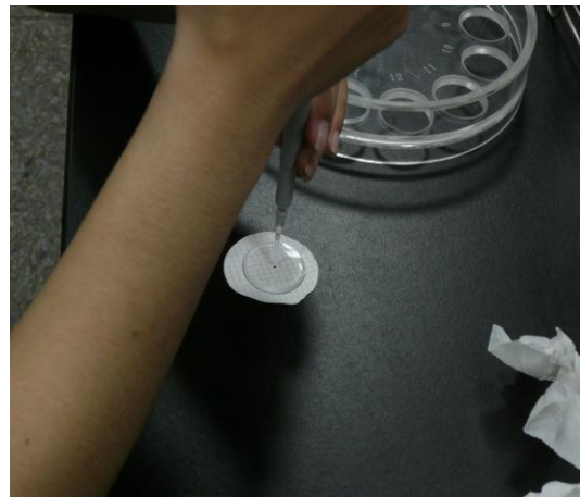
H. 消化液及 Ga 均勻混合後滴於 石英片上
