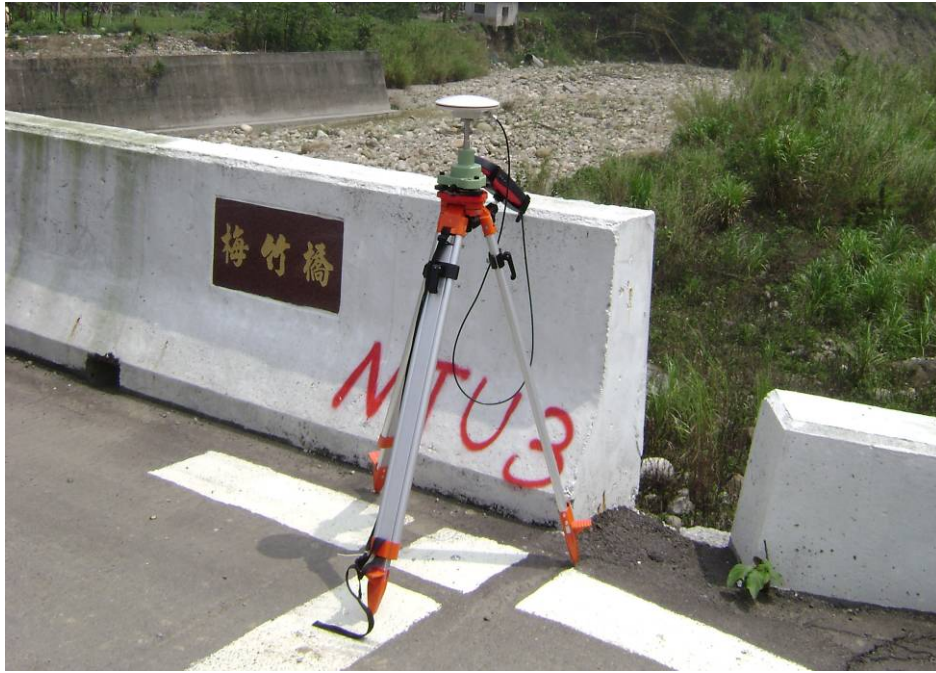
圖 54 NTU03 控制點 GPS 測量
