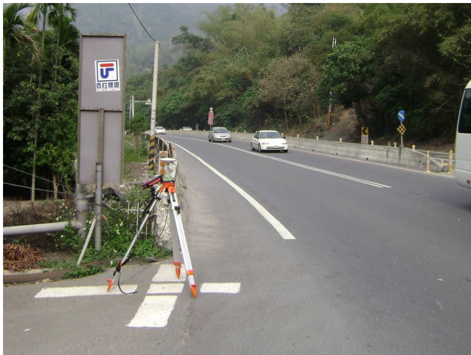
圖 55 NTU08 控制點 GPS 測量
