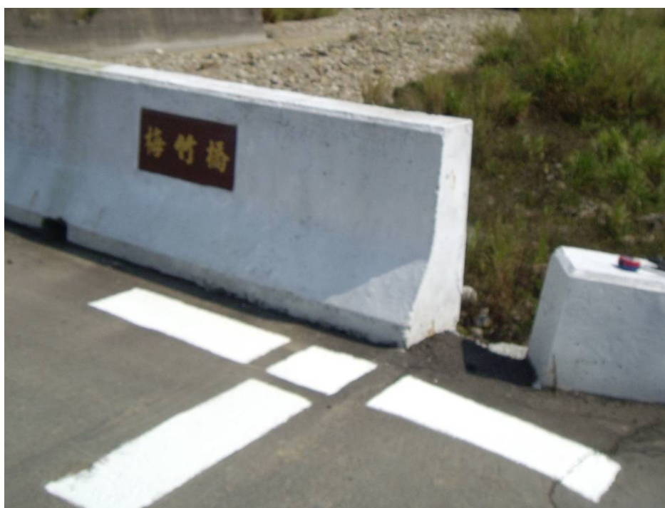
圖 52 NTU03 控制點佈標，位在梅竹橋旁(230671,2658997)
