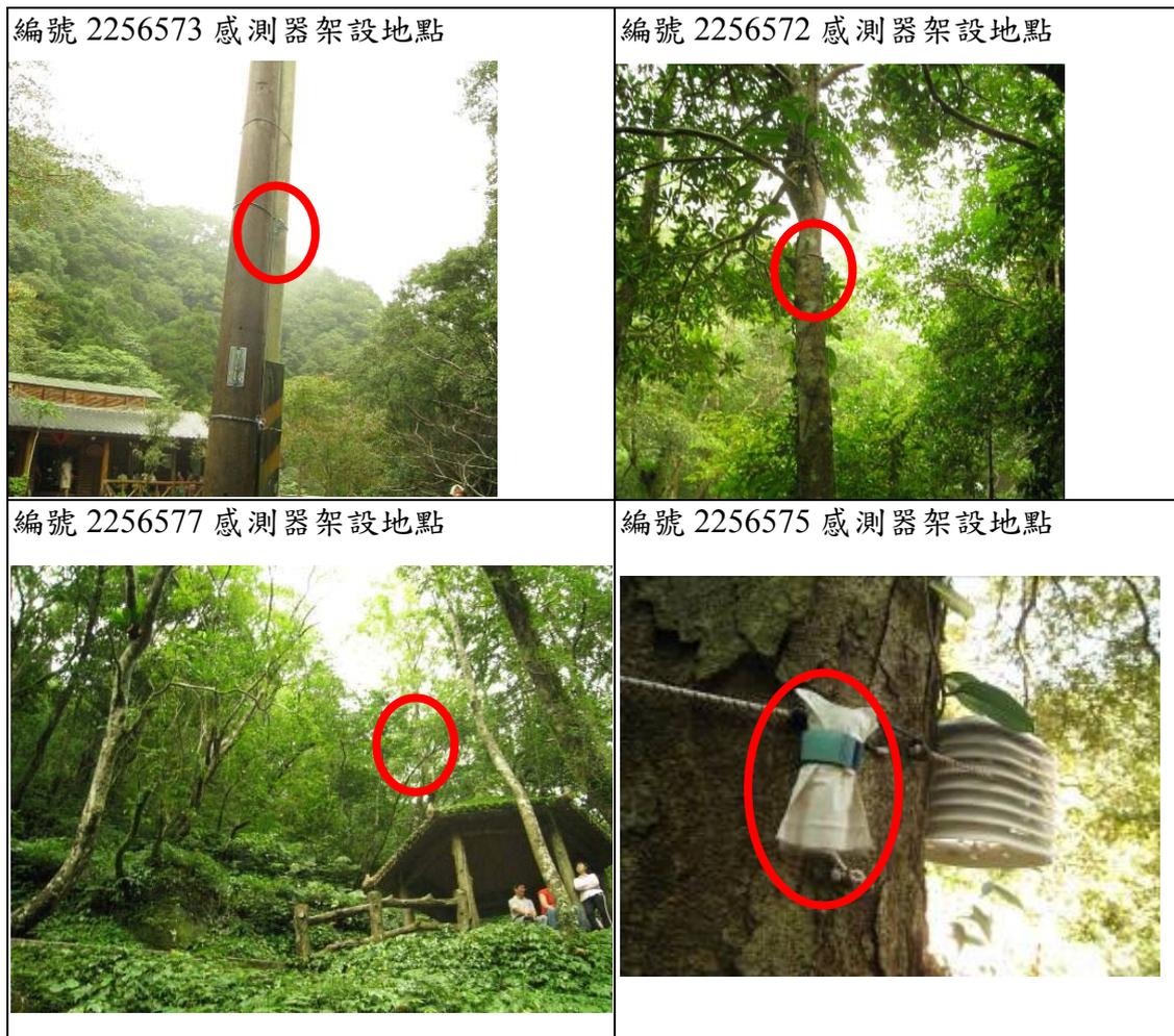
圖 43 HOBO 溫濕度感測器架設照片
