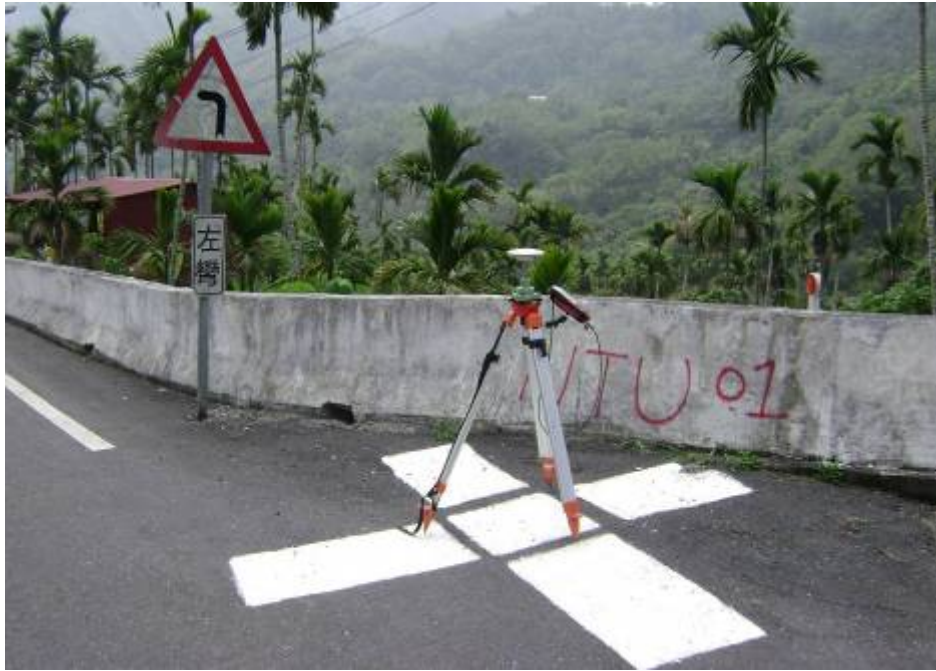
圖 28 NTU01 控制點佈標，位在 136 號省道 53K 附近(座標 230644,2660371)
