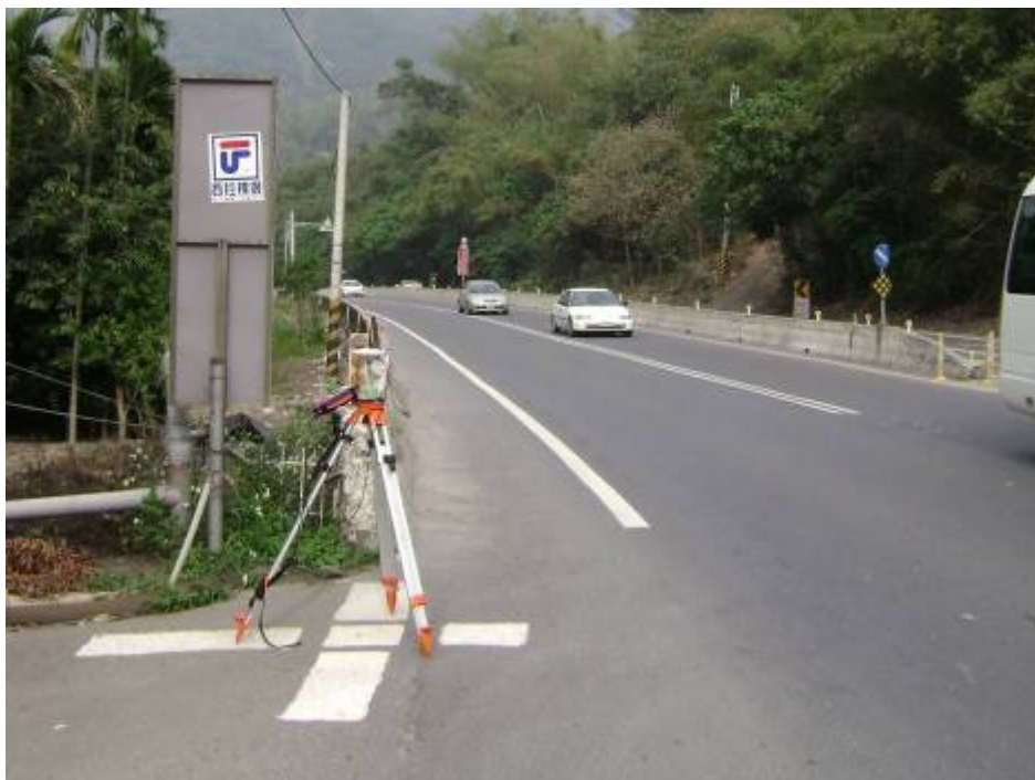
圖 29 NTU08 控制點 GPS 測量
