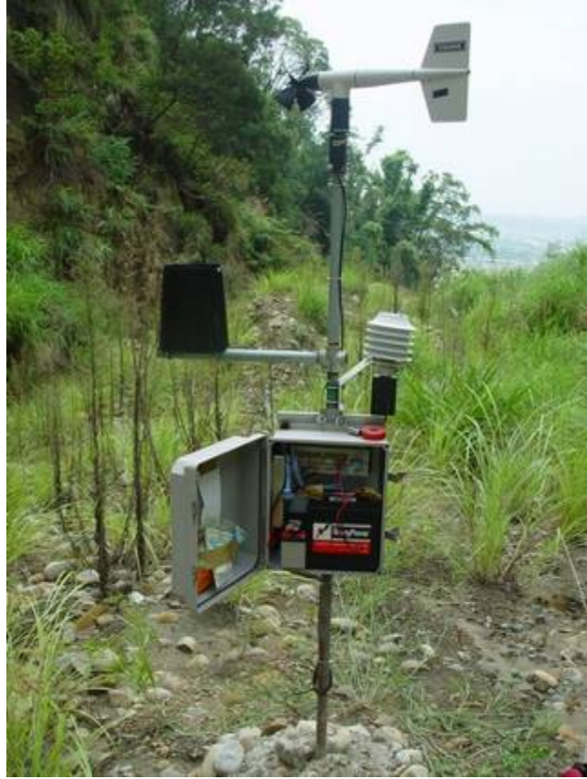
圖 4.1 本研究在 4 號集水區架設之自計式氣象站
