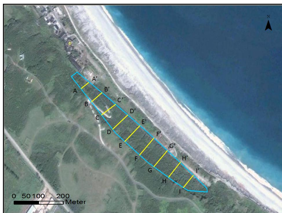
圖 5-68 2613 號飛砂防止保安林帶寬度量測之截面線
