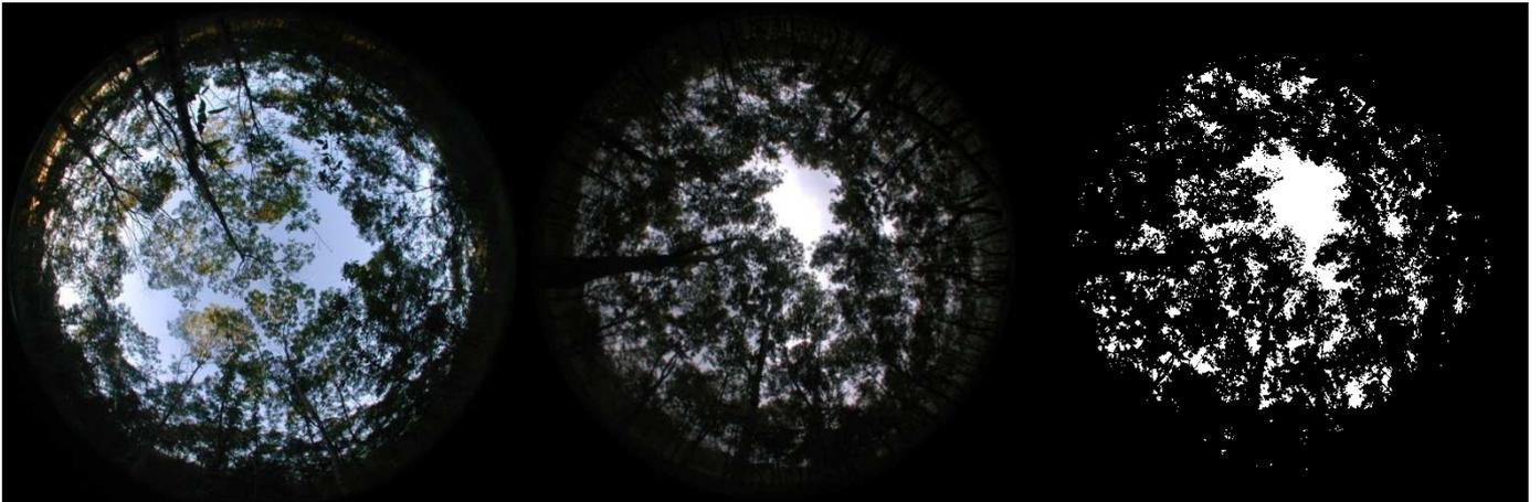
圖 6 半球面影像。左：斑光情形。中：正確半球面影像。右：軟體處理後之影像。
