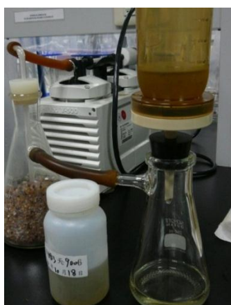
圖 8. 以抽氣幫浦及 0.45\mu m 濾膜過濾水樣。
