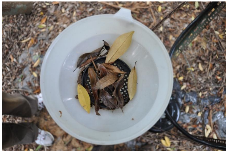
圖 5. 雨水收集裝置漏斗攔截枯落物情形以及漏斗示意圖。
