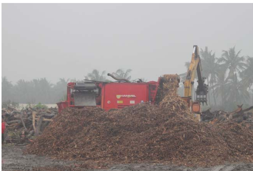
圖 19、搗切機於現場破碎漂流木狀態
