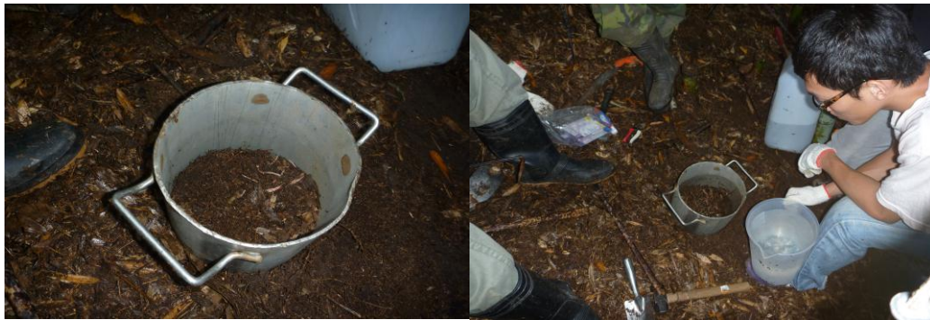
圖 16. 土壤入滲速率調查之示意圖。
