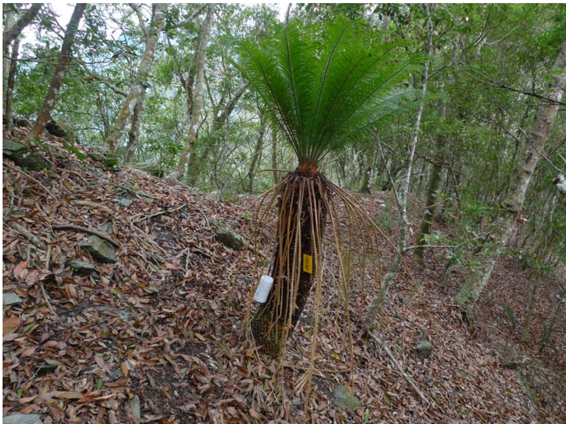
圖 1、架設溫度記錄器 1a：研究人員於台東蘇鐵上架設溫度記錄器。1b：記錄器外側加上白色保護罩，避免記錄器受到野生動物破壞。
