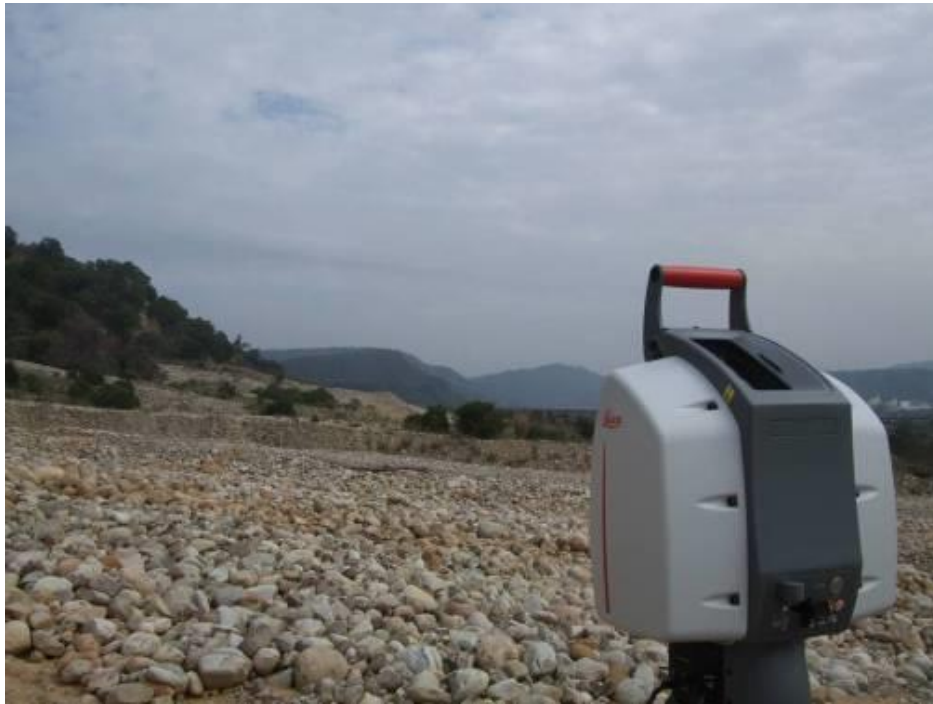
圖 3.19 Lacia Scanstation 2 掃描儀器
