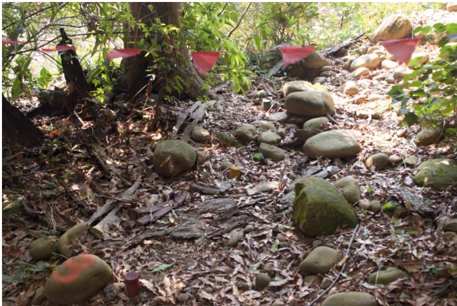
上圖為三號監測站，相較其他監測站，三號監測站的礫石表面布滿青苔，礫石以中礫至巨礫為主，且地表佈滿枯葉，顯示此處的侵蝕現象較不明顯，呈現亞穩定階段。
