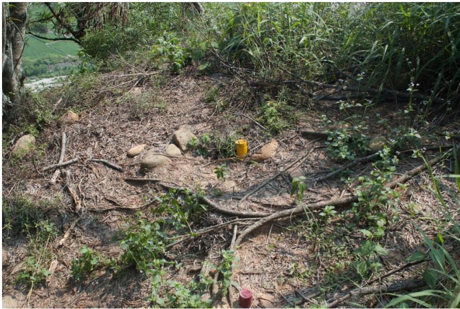
上圖為二號監測站，地勢平坦，可見樹根出露，顯示此處的土壤侵蝕嚴重，但邊坡後退不明顯，與前期相比變化不大。
