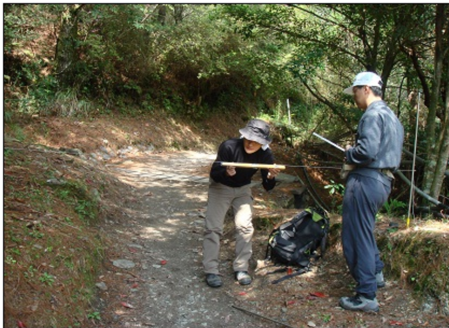
圖 3-6 步道沖蝕監測方式示意圖
