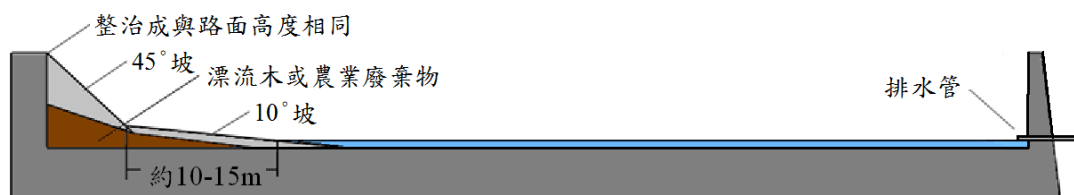
圖 8 塭堤回填剖面圖。
