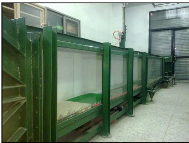
圖 4-19 風洞試驗段側邊之觀察視窗
