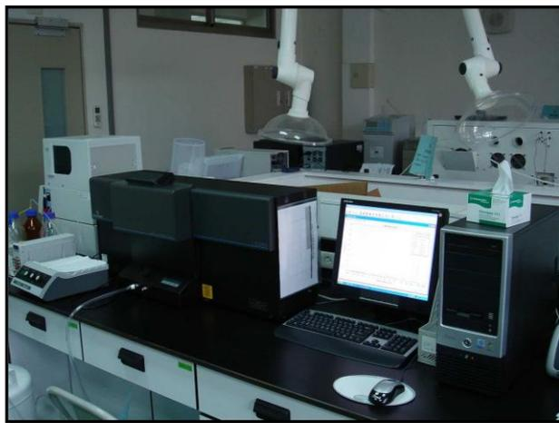
圖 4-15 雷射光繞射粒徑分析儀(Coulter LS230, Beckman)
