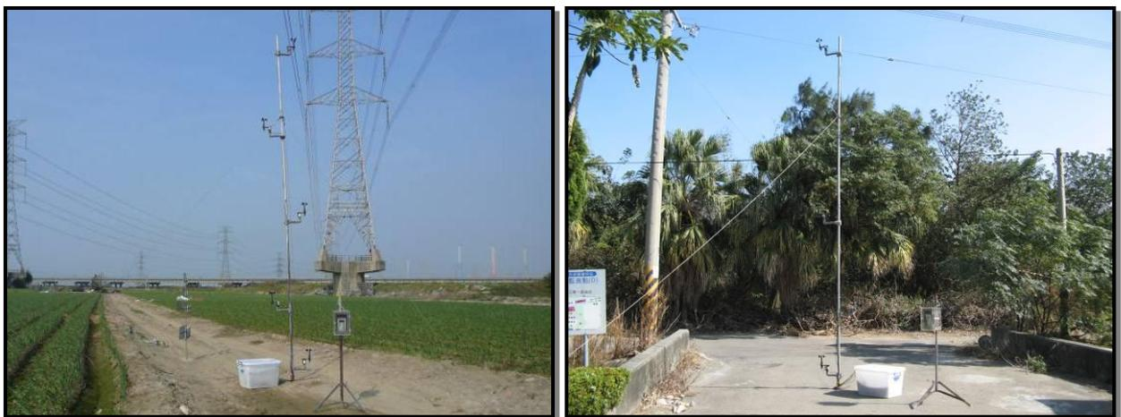
圖 4-2 多層風速計觀測情形
