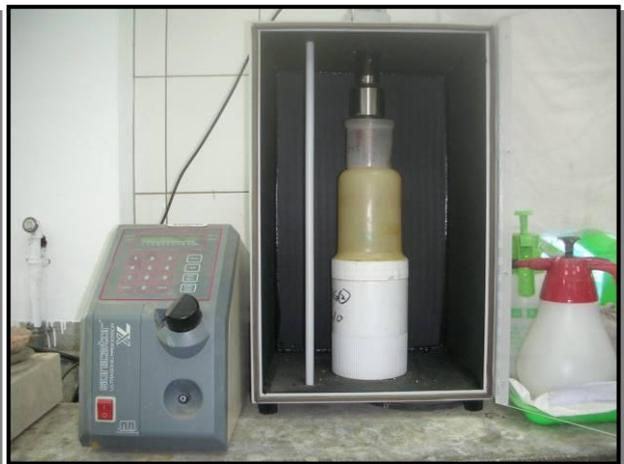
圖 4-17 超音波分散器
