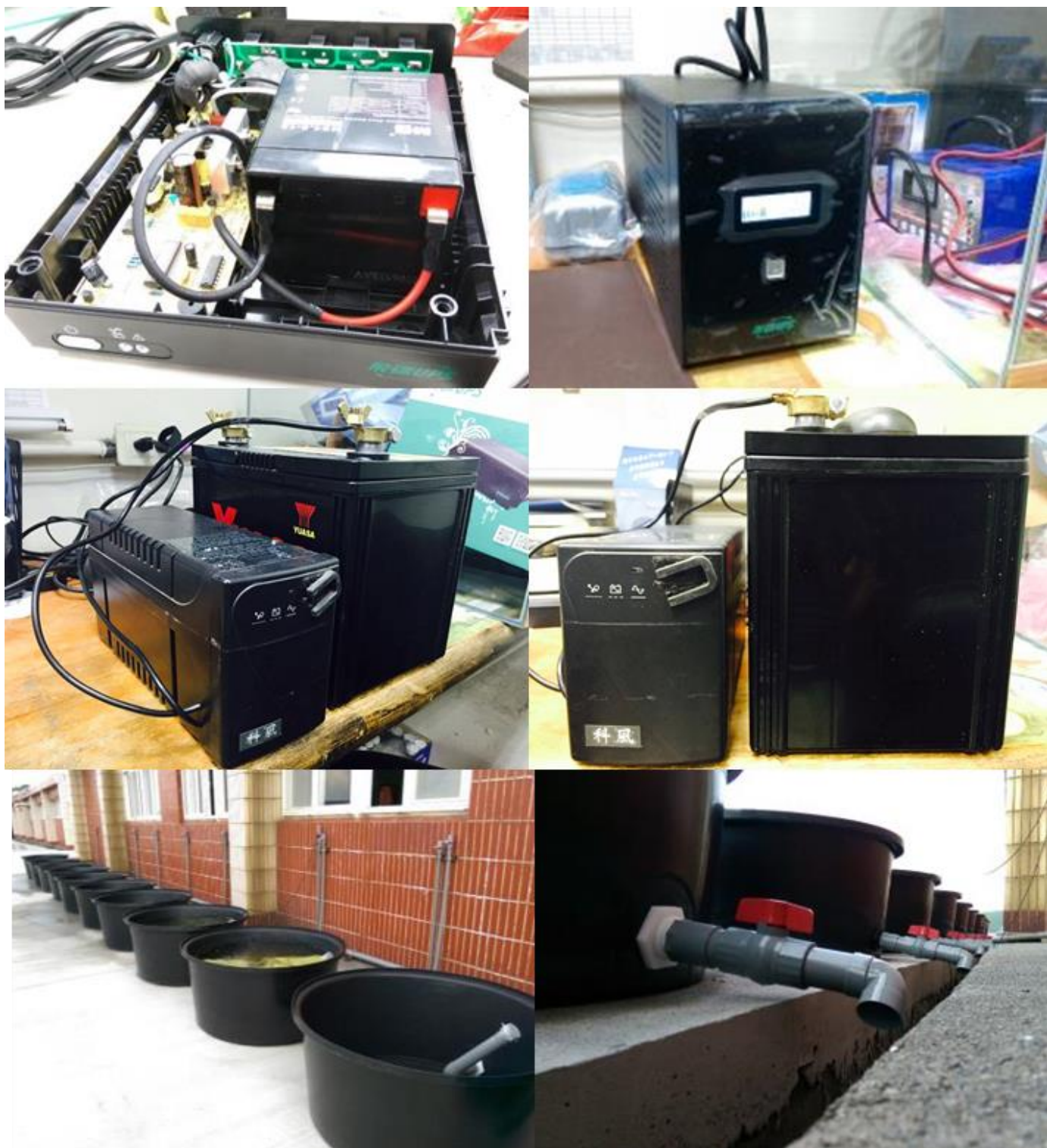
圖 10、不斷電系統(UPS)架設與建置及青鱗魚增桶測置
