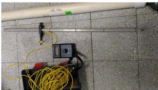
圖6-15 旋杯式流速儀
