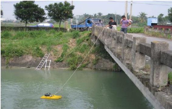
圖6-17 以拖拉方式進行量測
