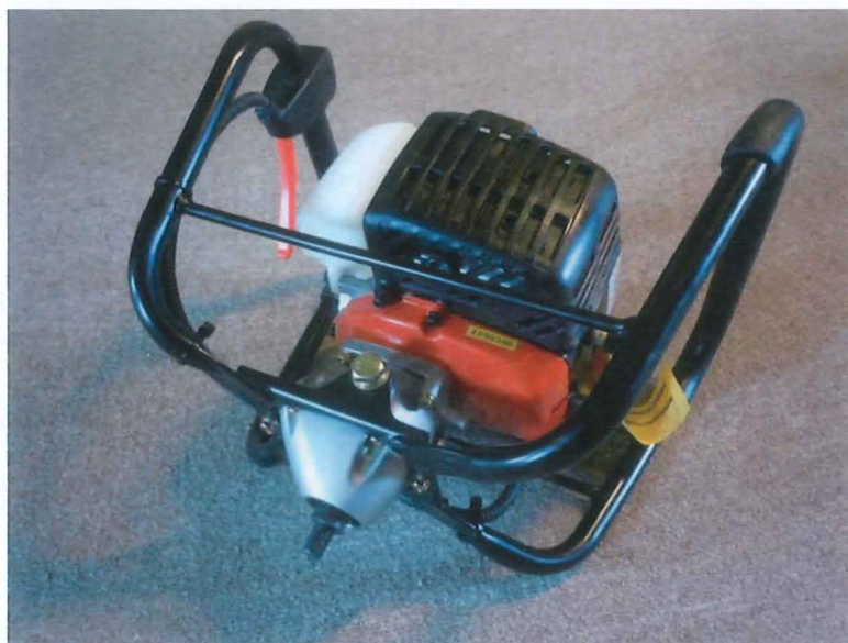
圖 5.7 輕便岩芯鑽探設備。
