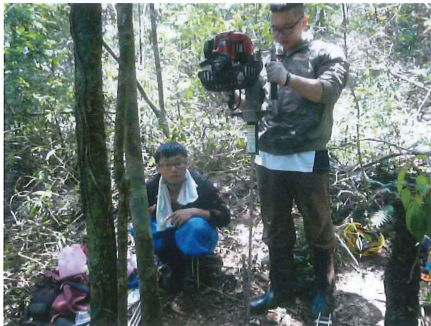
圖5.6 汽油引擎活塞打樁機貫入試驗現地測試照片，圖中為打樁機貫入設置完成準備進行貫入的情形（2016.07.27）。
