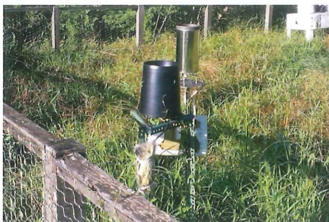
圖 3.4 本研究在福山氣象站設置的兩座傾斗式雨量筒
