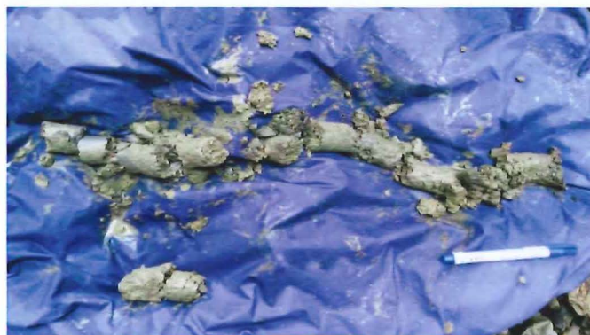
圖 5.24 利用採土打樁管取出之土芯。
