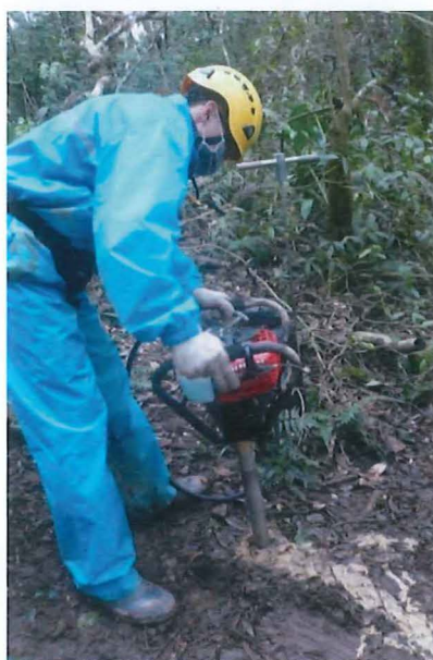
圖 5.21 輕便岩芯鑽探設備（鑽井機）現地試用照片（2016/01/27）。
