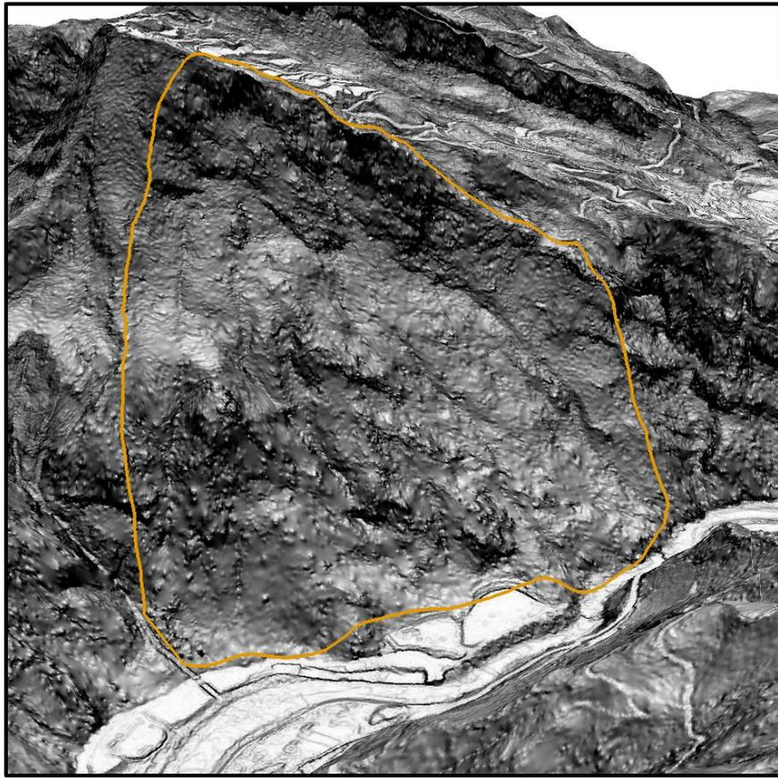
圖 3-3.2、潛在大規模崩塌編號新竹縣-尖石鄉-D022 三維高精度數值地形判釋成果圖
