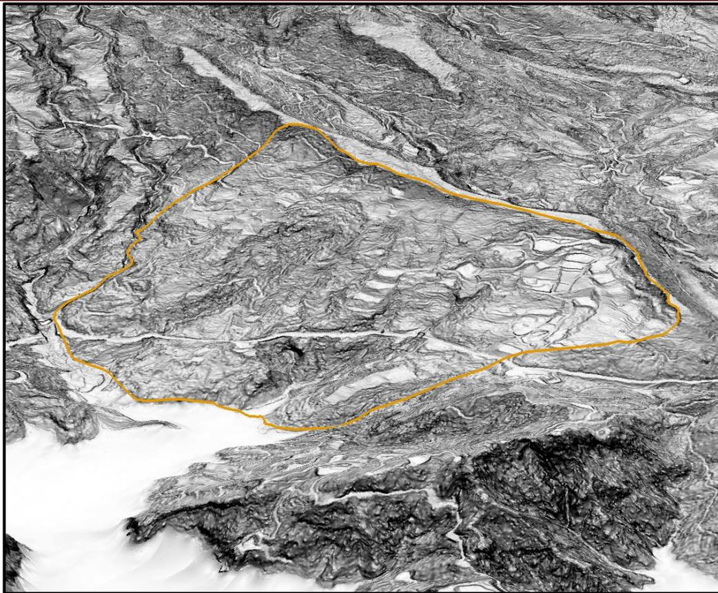
圖 3-3.14、潛在大規模崩塌編號嘉義縣-大埔鄉-D037 三維高精度數值地形判釋成果圖
