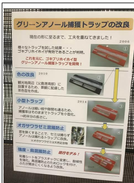
圖 5-1-9 綠變色蜥黏膠陷阱改良與修正進程
