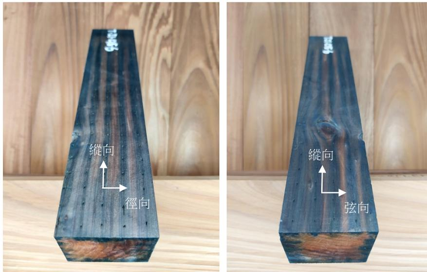
圖4 針狀刺縫10000點/m<sup>2</sup> 防腐處理材距材面4.5 mm之徑切面與弦切面顯色結果
