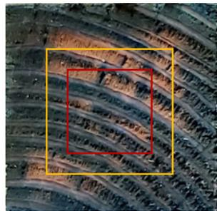
圖3 防腐劑滲透度測定區域(黃色線距邊緣1 cm，紅色線距邊緣1.5 cm)
