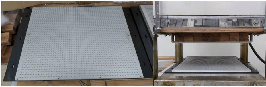
圖1 平板鋼針治具與利用熱壓機進行刺縫
