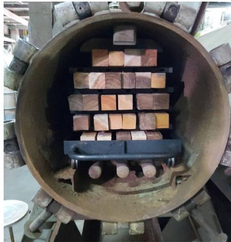
圖2 試材置入加壓防腐槽內
