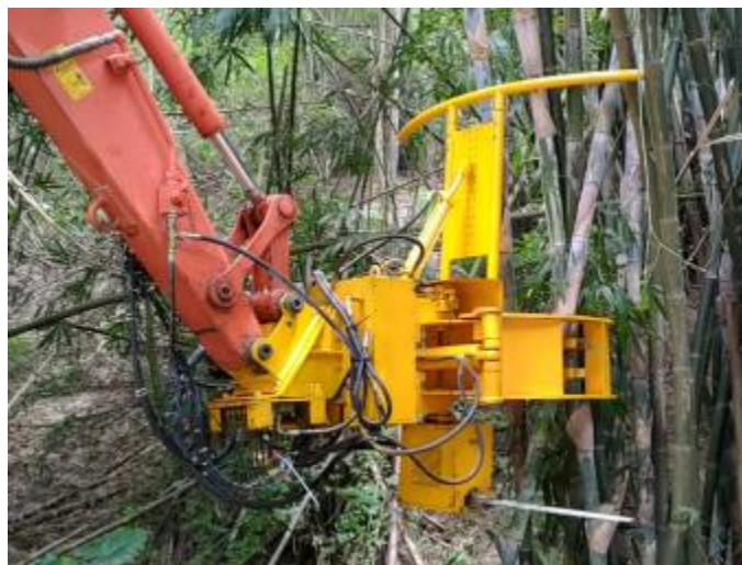
圖 56. 伐竹機具安裝 45 度轉接座，作業時重心較穩固
