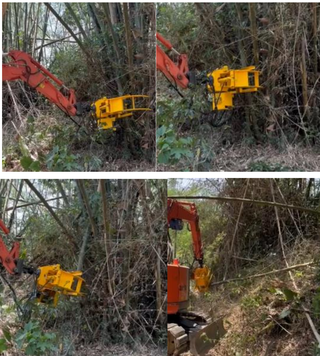
圖 50. 採伐雛形機於叢生竹林測試採伐功能
