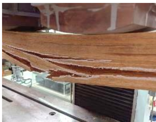
圖 87. 以傳統臥式集成機台壓製之束狀竹層積材集成材於抗彎破壞試驗後之破壞型態。（L100 構成）
