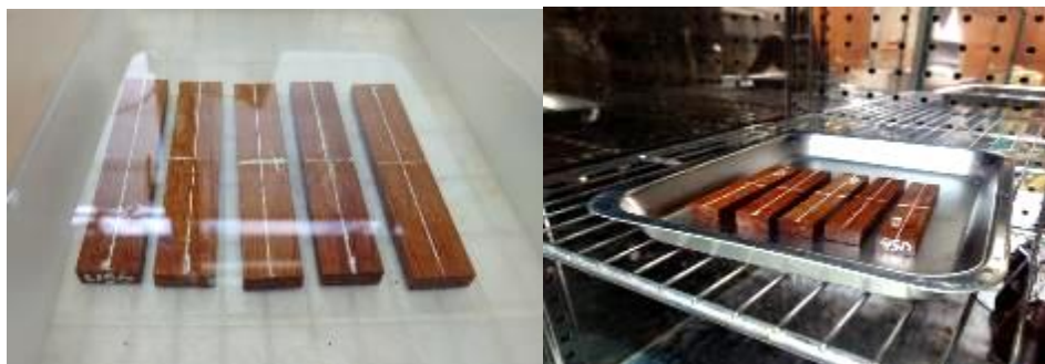
圖 73. 束狀竹層積材全收縮率試驗照
