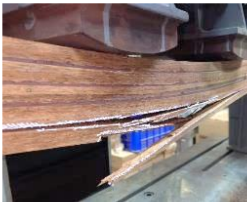
圖 89. 以新型立式集成機台壓製之束狀竹層積材集成材於抗彎破壞試驗後之破壞型態。(L100 構成)
