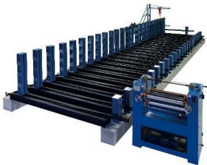
圖 5. 集成材結構樑膠合成型機示意圖
