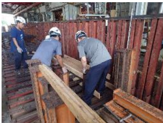
圖 83. 束狀竹層積材集成元之上機配置作業（臥式）。
