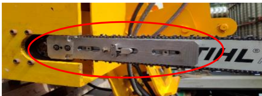
圖 46. 鏈鋸導板加裝穩定支撐板
