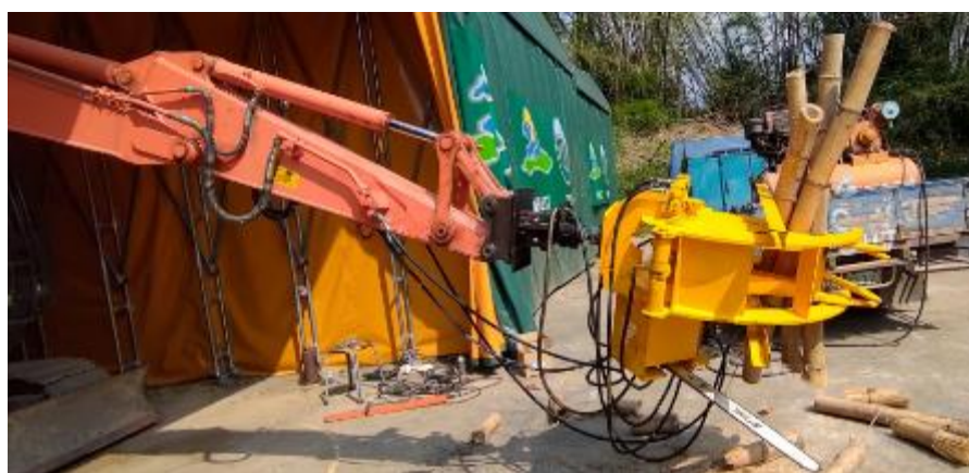
圖 54. 挖掘機需將前臂伸的很長，才能操作伐竹
