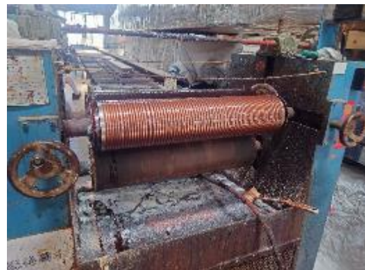
圖 82. 束狀竹層積材集成元之布膠流水線作業。
