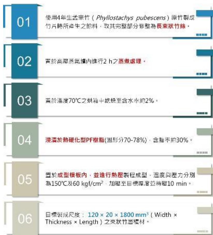
圖 71. 束狀竹層積材之研製流程
