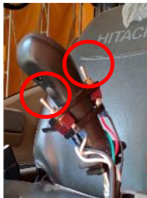
圖 58. 挖掘機之左操縱桿加裝 2 組小型搖桿
