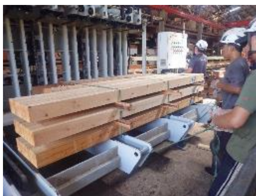
圖 106. 束狀竹層積材集成材現場製程（配置上機）。
