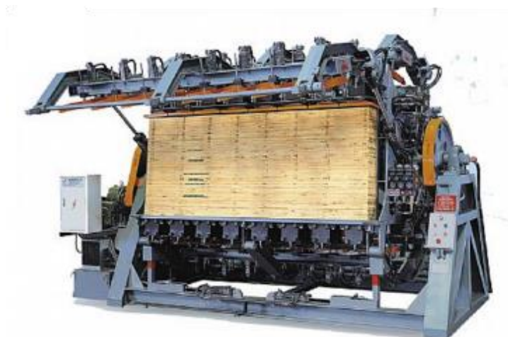
圖 7. 單面臥式油壓拼板機示意圖
