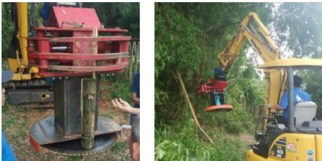
圖 30. 元宇公司改良伐竹夾具-加裝圓盤鋸
