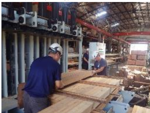
圖 85. 束狀竹層積材集成元之上機配置作業（立式）。
