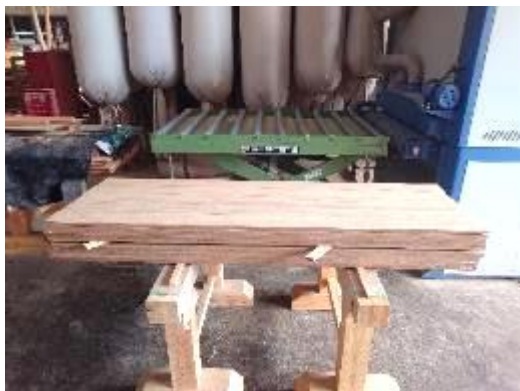
圖 79. 束狀竹層積材集成元之表面粗糙化作業 1。
