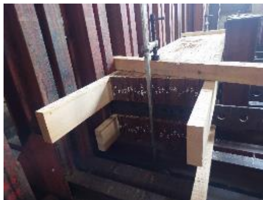
圖 84. 束狀竹層積材集成材之集成壓製持壓作業（臥式）。
