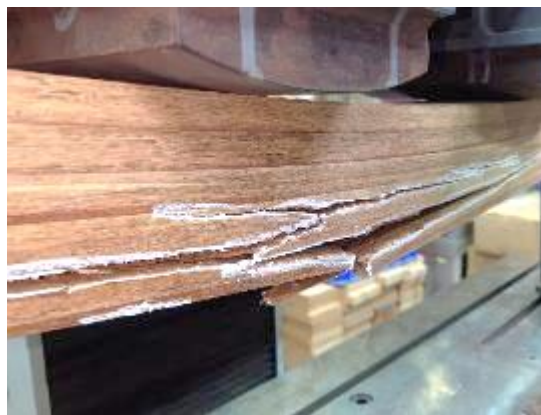
圖 90. 以新型立式集成機台壓製之束狀竹層積材集成材於抗彎破壞試驗後之破壞型態。(L110 構成)
