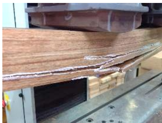
圖 88. 以傳統臥式集成機台壓製之束狀竹層積材集成材於抗彎破壞試驗後之破壞型態。（L110 構成）
