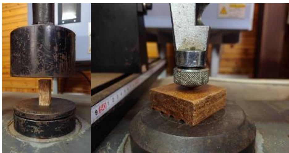
圖 74. 束狀竹層積材抗壓強度試驗照
