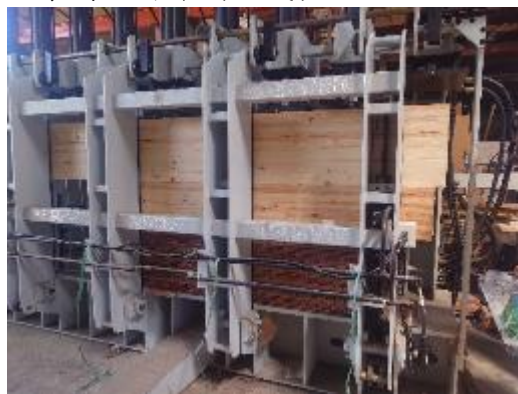
圖 86. 束狀竹層積材集成材之集成壓製持壓作業（立式）。
