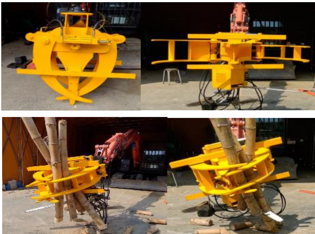
圖 49. 新式竹材採伐雛形機於實驗室測試功能
