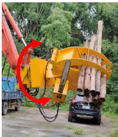
圖 52. 新式旋轉機構，動作順暢靈活
