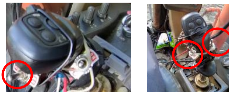
圖 59. 挖掘機之左操縱桿加裝 3 組小型搖桿
