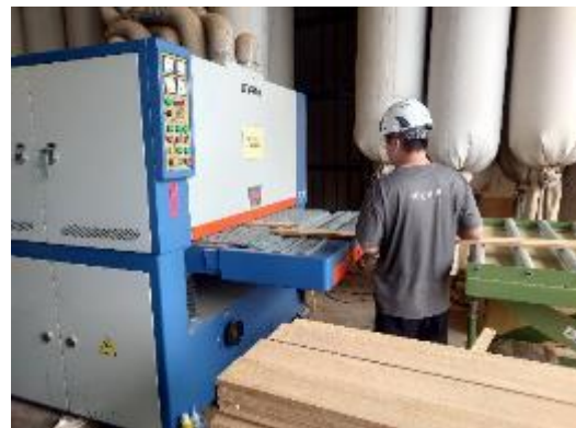
圖 80. 束狀竹層積材集成元之表面粗糙化作業 2。
