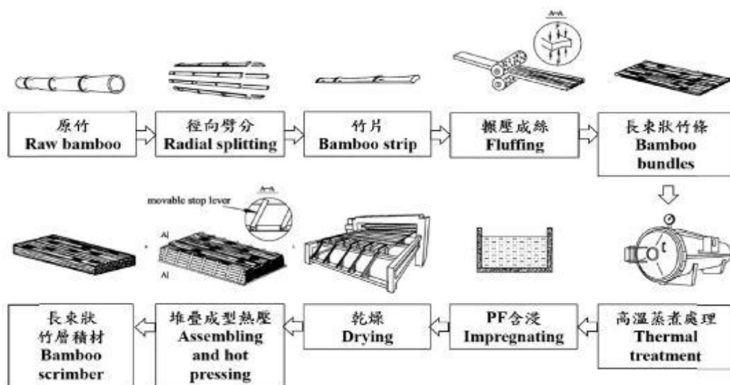
圖 70. 一般束狀竹層積材之製備流程圖示範例 (Yu et al.2015)
