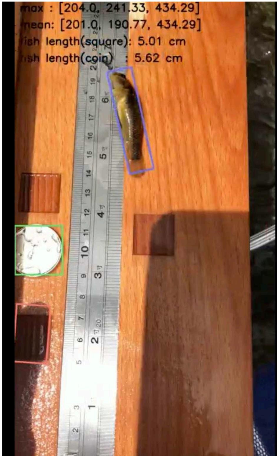
本次專案是一個實驗性項目，旨在透過錄影方式進行魚種分類以及體長、體全長的偵測。在實驗結果中，系統將偵測並量測魚版上的方格與魚種。一旦魚種出現於畫面
