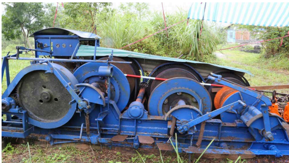
圖 7 三捲筒橈式集材機
