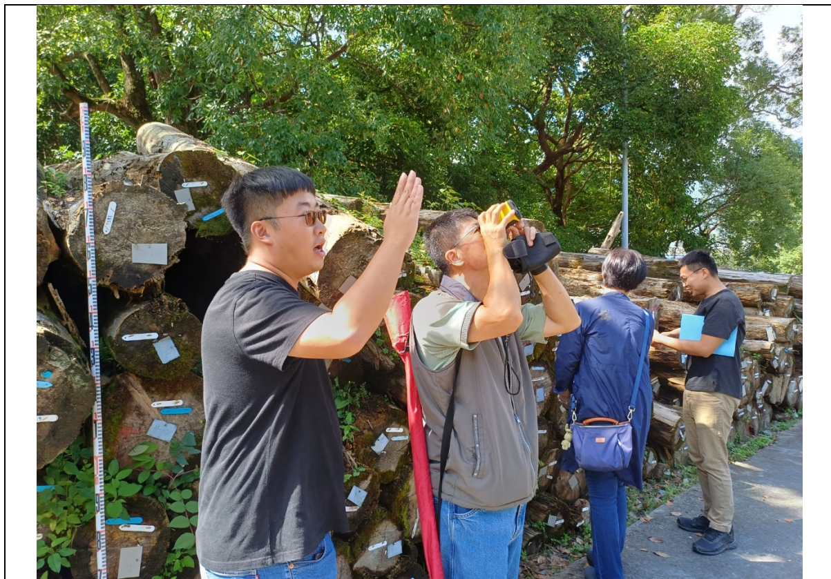
圖 18 陳廷安講師指導學員使用雷射測距儀
