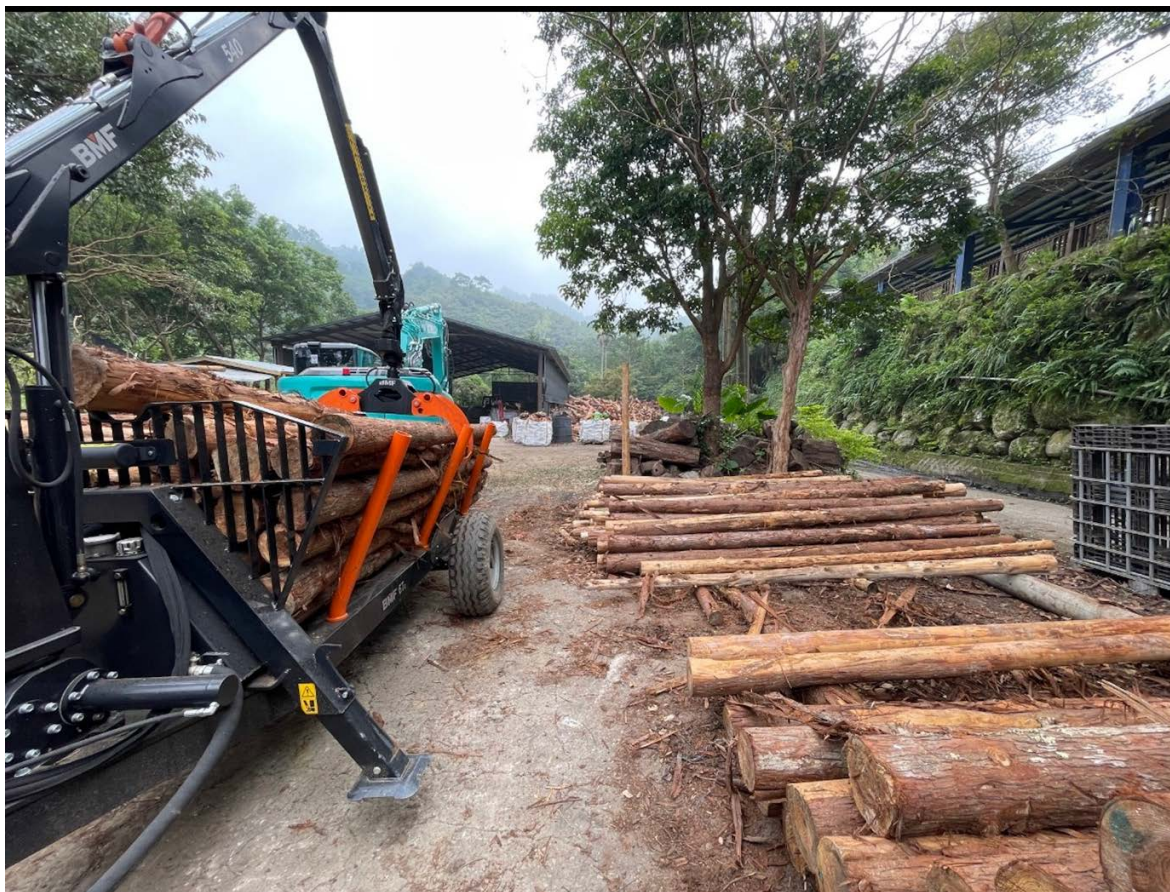
圖 13 BMF 6T2 原木裝車作業
