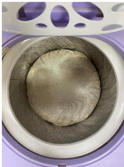
圖 20、浸泡後的竹材以濾袋包覆，使用脫水機排乾廢液
