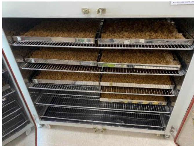
圖 23、竹材以烘乾機 40~45°C 烘乾
