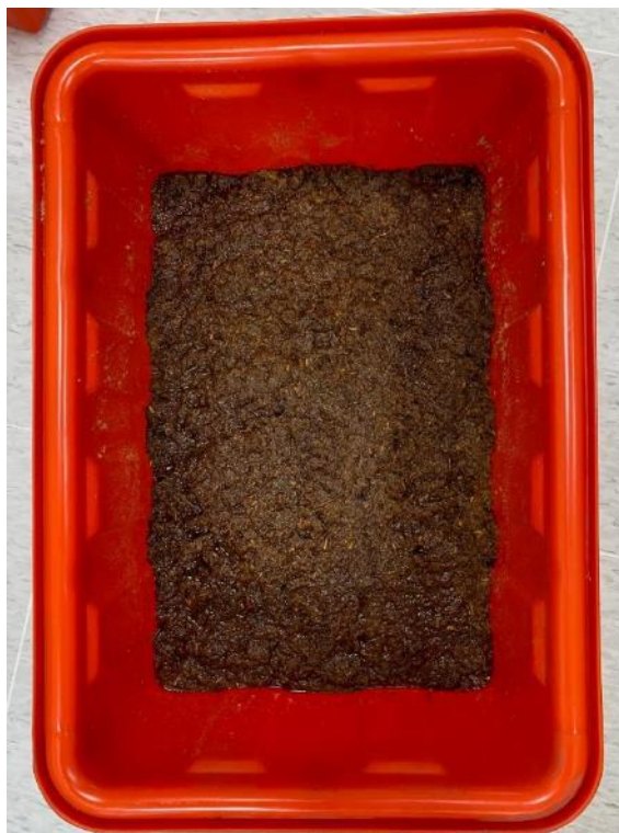
圖 19、竹材浸泡重量百分濃度為 5%的氫氧化鈉水溶液
