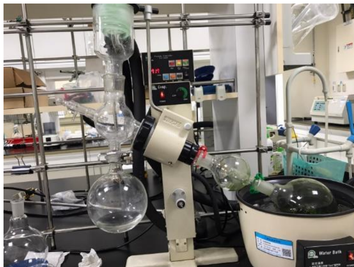
圖 8、竹葉萃取液減壓濃縮
