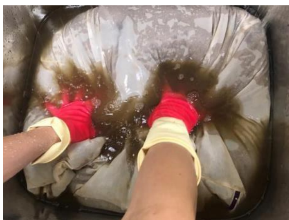
圖 22、竹材以濾袋包覆，以自來水浸泡搓揉
